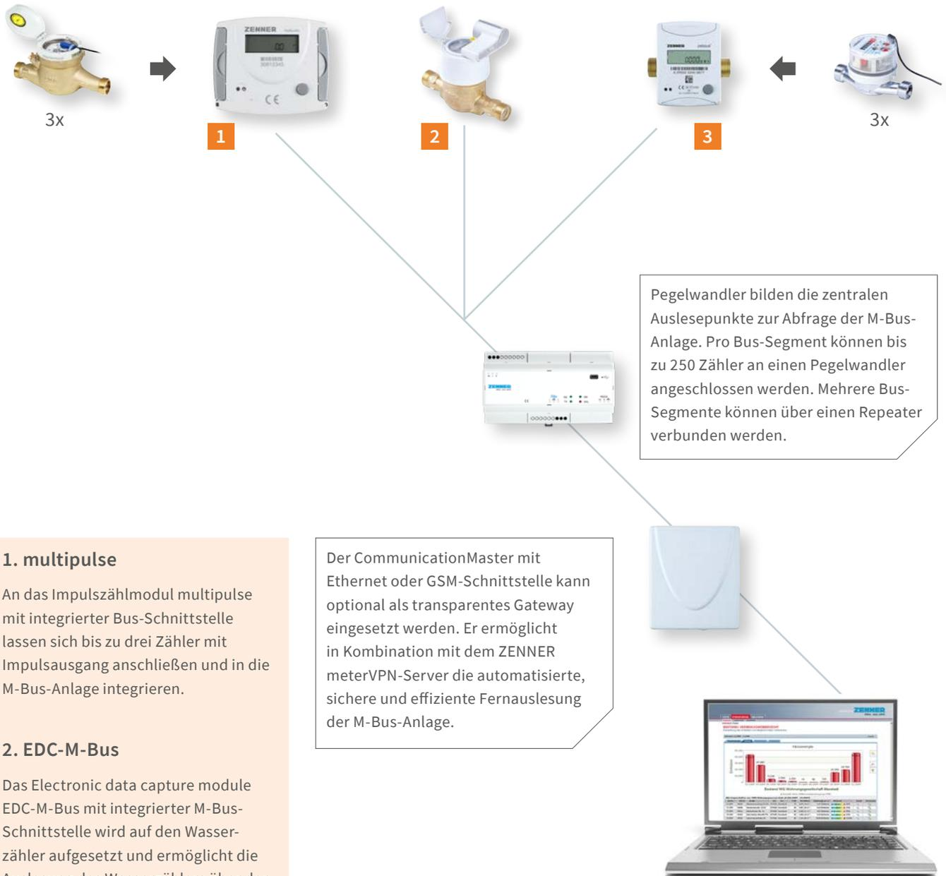
Pegelwandler bilden die zentralen Auslesepunkte zur Abfrage der M-Bus-Anlage. Pro Bus-Segment können bis zu 250 Zähler an einen Pegelwandler angeschlossen werden. Mehrere Bus-Segmente können über einen Repeater verbunden werden.
