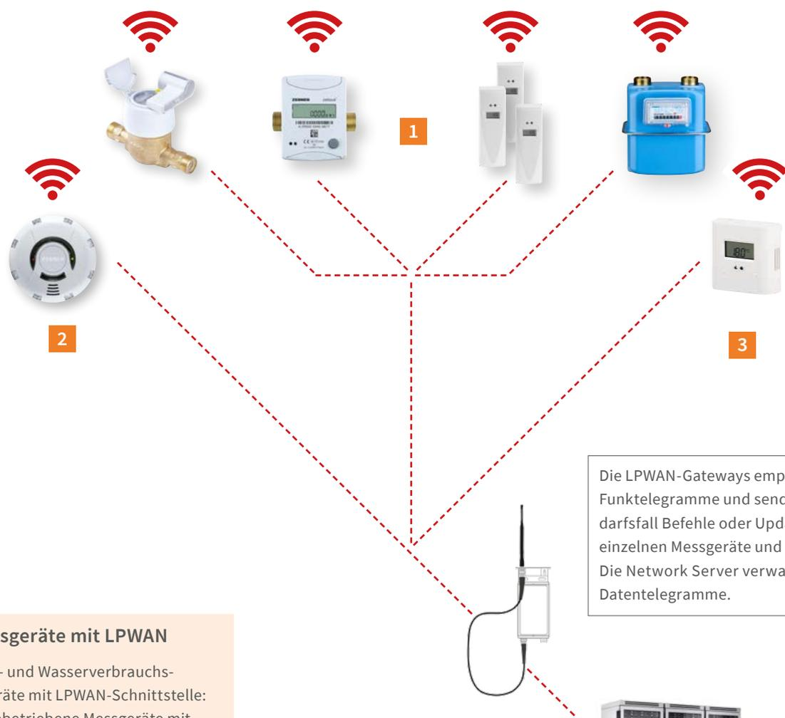
Die LPWAN-Gateways empfangen die Funktelegramme und senden im Bedarfsfall Befehle oder Updates an die einzelnen Messgeräte und Sensoren. Die Network Server verwalten die Datentelegramme.
