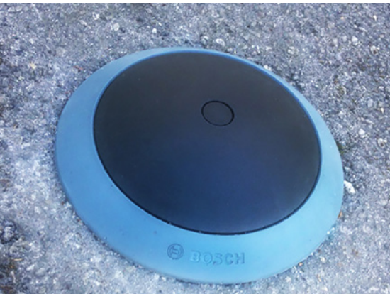
Parkplatzsensoren erleichtern die Suche nach einem freien Parkplatz (Quelle: Zenner)
